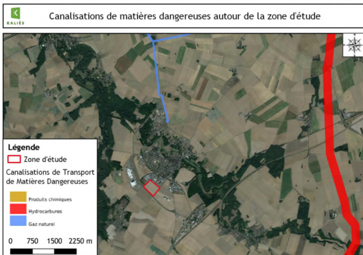
Figure 22 : Localisation des canalisations de Transport de Matières Dangereuses
